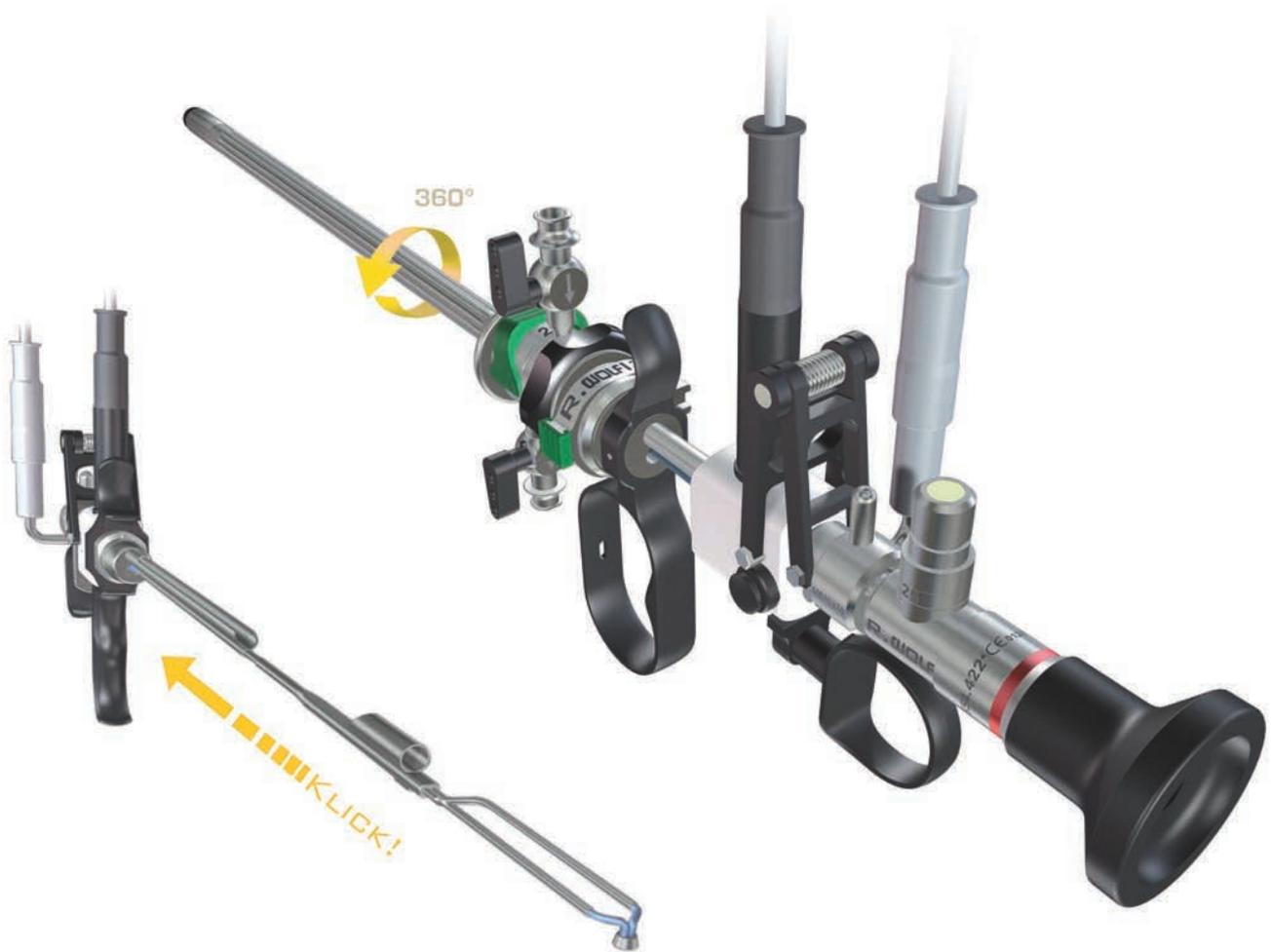
Особый замок «easy-click» между электродом и рабочим элементом делает смену электрода особенно простой и легкой. Нейтральный контакт на проксимальном конце рабочего элемента играет роль нейтрального электрода и тем самым направляет ток по биполярному кабелю.
